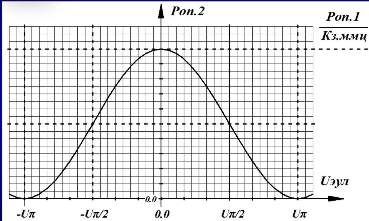
Зависимость мощности оптического сигнала
