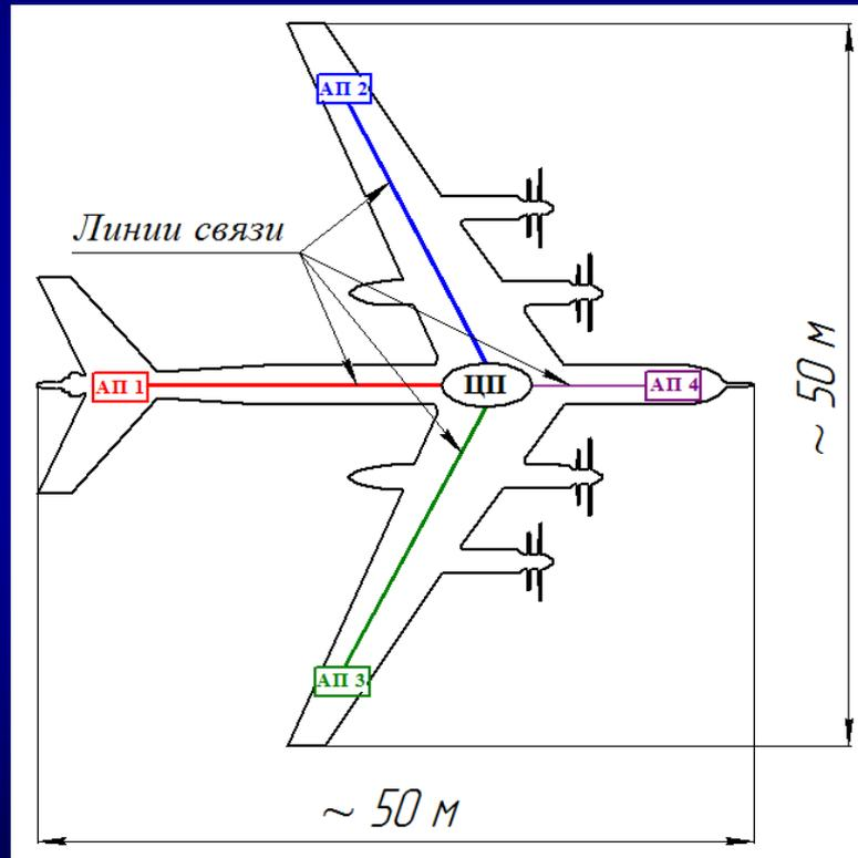
Возможный вариант размещения антенных постов (АП) относительно центрального поста (ЦП) на "большом" самолёте
