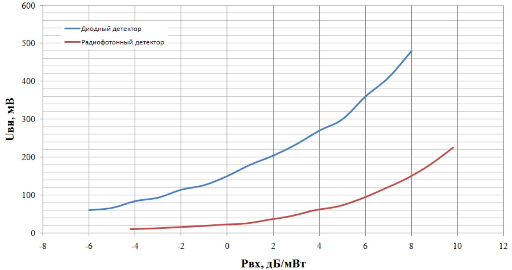
Зависимость  $U_{вн}$  от мощности входного радиосигнала ( $P_{вх}$ ) при несущей частоте 10 ГГц
