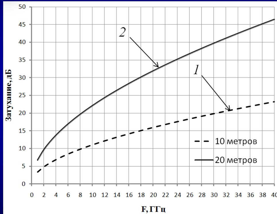
АЧХ линий связи длиной 10 и 20 м, реализованных с использованием коаксиального кабеля LL160 фирмы Harbour Industries
