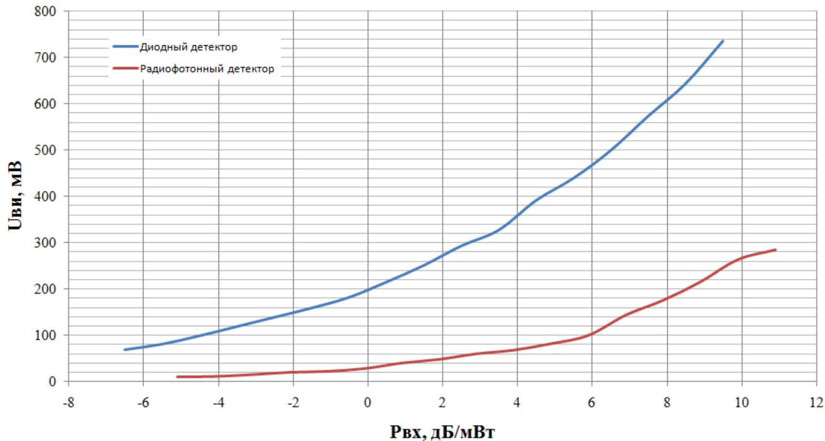
Зависимость  $U_{вн}$  от мощности входного радиосигнала ( $P_{вх}$ ) при несущей частоте 5 ГГц
