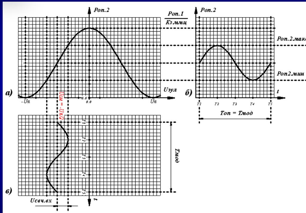
Модуляция оптического сигнала при подаче напряжения
