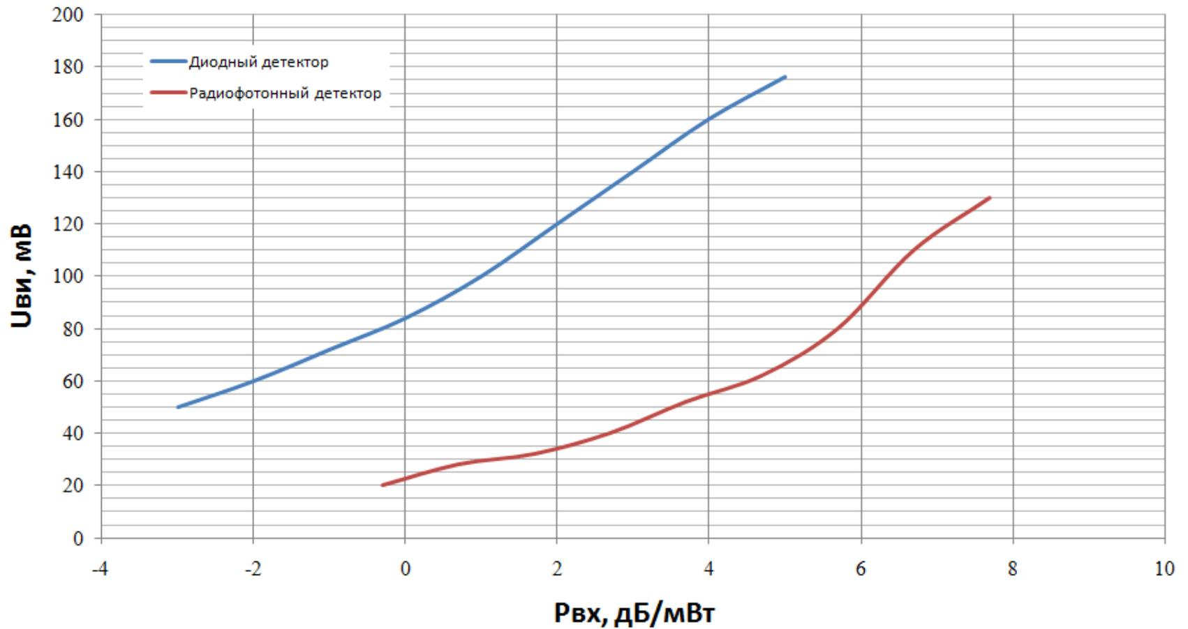
Зависимость  $U_{ви}$  от мощности входного радиосигнала ( $P_{вх}$ ) при несущей частоте 15 ГГц
