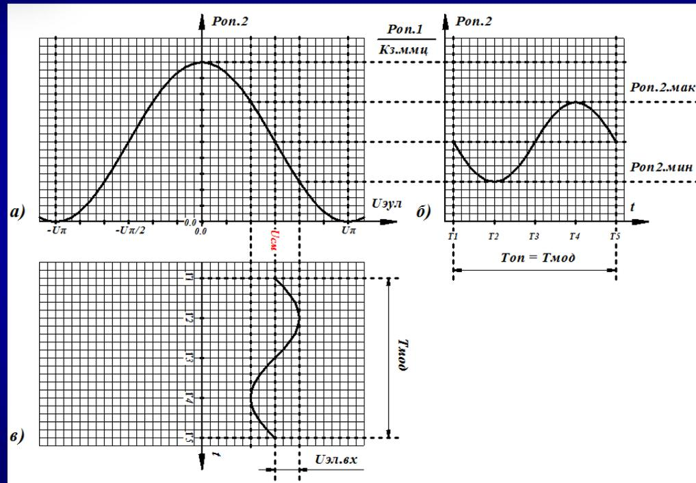
Модуляция оптического сигнала при подаче напряжения
