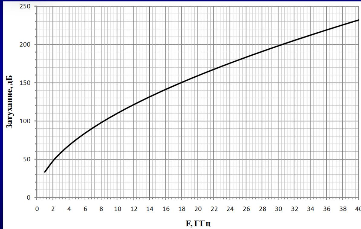
АЧХ линии связи длиной 100 м, реализованной с использованием коаксиального кабеля LL160 фирмы Harbour Industries
