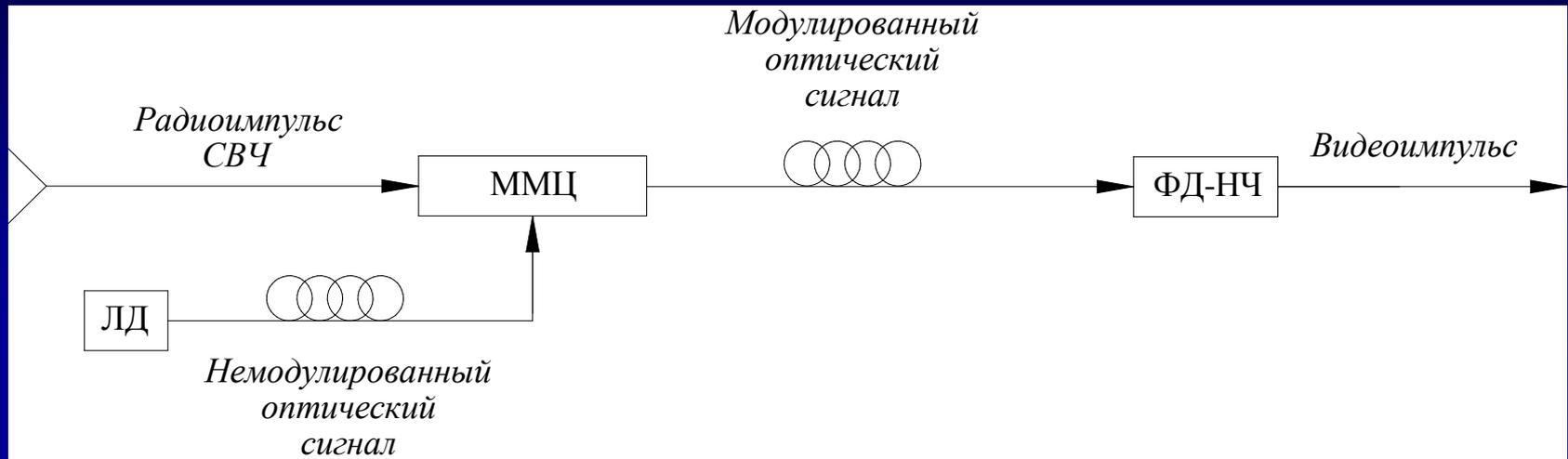
Структурная схема сверхширокополосного согласованного амплитудного детектора
