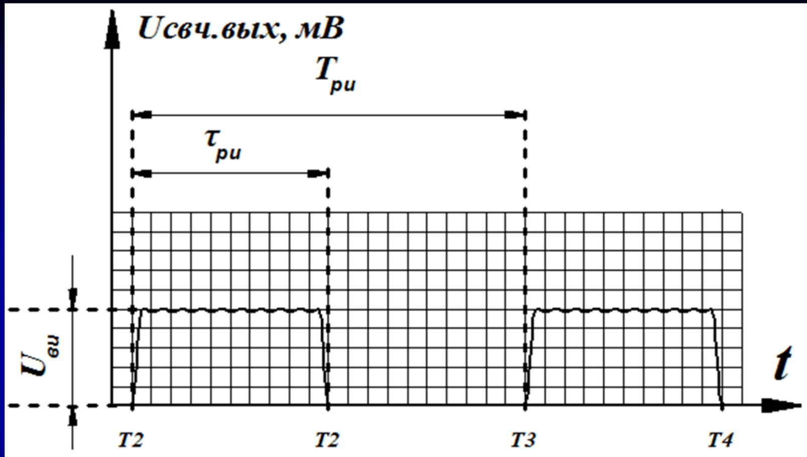
Временная развёртка  $U_{\text{фд}}$  при подаче напряжения смещения  $U_{\text{см}} = +U_{\pi}$  и последовательности радиоимпульсов длительностью  $\tau_{\text{ри}}$ , периодом следования  $T_{\text{ри}}$  и амплитудой  $U_{\text{эл.вх}}$  для случая использования низкочастотного ФД.
