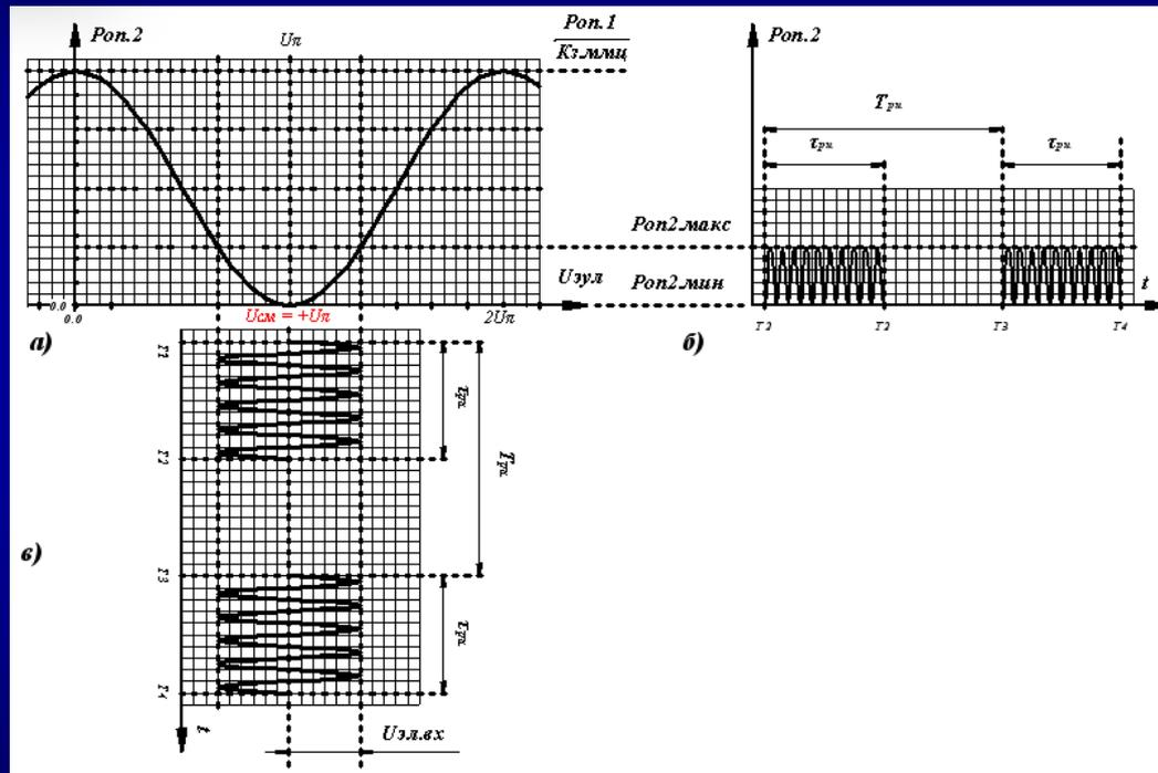
Модуляция оптического сигнала при подаче напряжения смещения  $U_{\text{см}} = +U_{\text{л}}$  и последовательности радиоимпульсов длительностью  $\tau_{\text{рп}}$ , периодом следования  $T_{\text{рп}}$  и амплитудой  $U_{\text{эл.вх}}$
