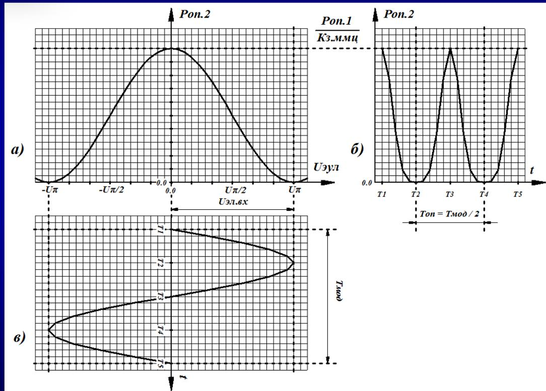
Модуляция оптического сигнала при подаче гармонического сигнала с периодом  $T_{мод}$  и амплитудой  $U_{эл.вх} = U_{л}$ ,  $U_{см} = 0$
