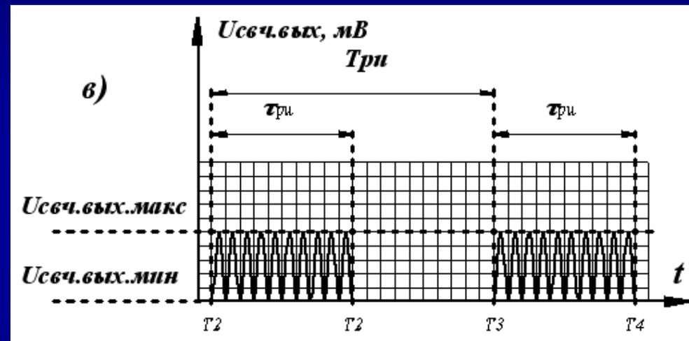
Временные развёртки оптических и электрических сигналов в различных точках тракта СА ВОЛС при подаче напряжения смещения  $U_{см} = +U_{п}$  и последовательности радиоимпульсов длительностью  $\tau_{ри}$ , периодом следования  $T_{ри}$  и амплитудой  $U_{эл.вх}$  для случая использования высокочастотного ФД.
