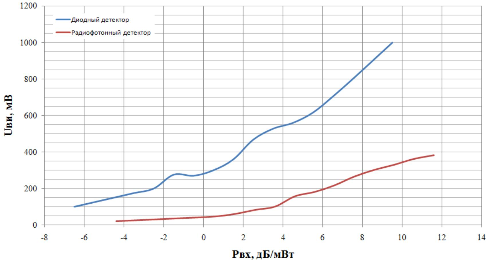
Зависимость  $U_{вн}$  от мощности входного радиосигнала ( $P_{вх}$ ) при несущей частоте 1 ГГц
