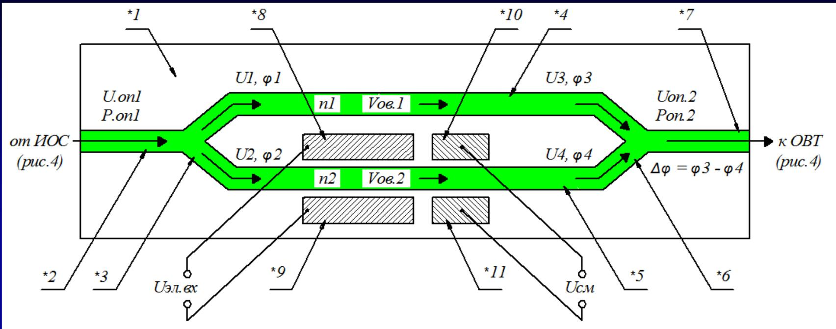
Схематическое изображение ММЦ на пластине из сегнетоэлектрика с дополнительными электродами для подачи напряжения смещения (\*1 - пластина из сегнетоэлектрика, \*2 - входной световодный канал, \*3 - входной Y-разветвитель, \*4, \*5 - первый и второй параллельные световодные каналы, \*6 - выходной Y-светвитель, \*7- выходной световодный канал, \*8, \*9 - первый и второй электроды управляющей линии, \*10, \*11 - первый и второй электроды для подачи напряжения смещения).
